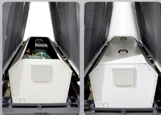
Die Verdichtergehäuse reduzieren durch die Verwendung schallschluckenden Materials drastisch die Lärmemission. Außerdem sind sie auf Gleitschienen ausziehbar, was die Wartungsarbeiten spürbar vereinfacht. Die Verdichter können auch über einen Haken von oben mit einem Kran entfernt werden.
