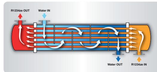
Durch den Einsatz von Rohrbündelverdampfern mit Einzeldurchfluss lassen sich dank des vollständigen Gegenstroms beim Wärmeaustausch exzellente Werte für die thermodynamische Effizienz erzielen.
